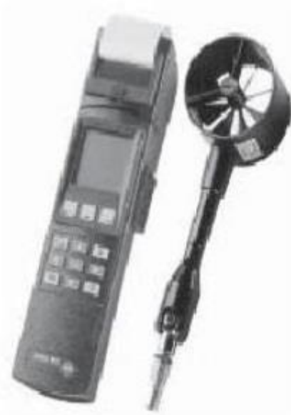
Figura 4.6: Velómetro o Anemómetro de Molinete
