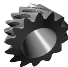
Fig. 3: Patrón de contacto del piñón óptimo teórico
