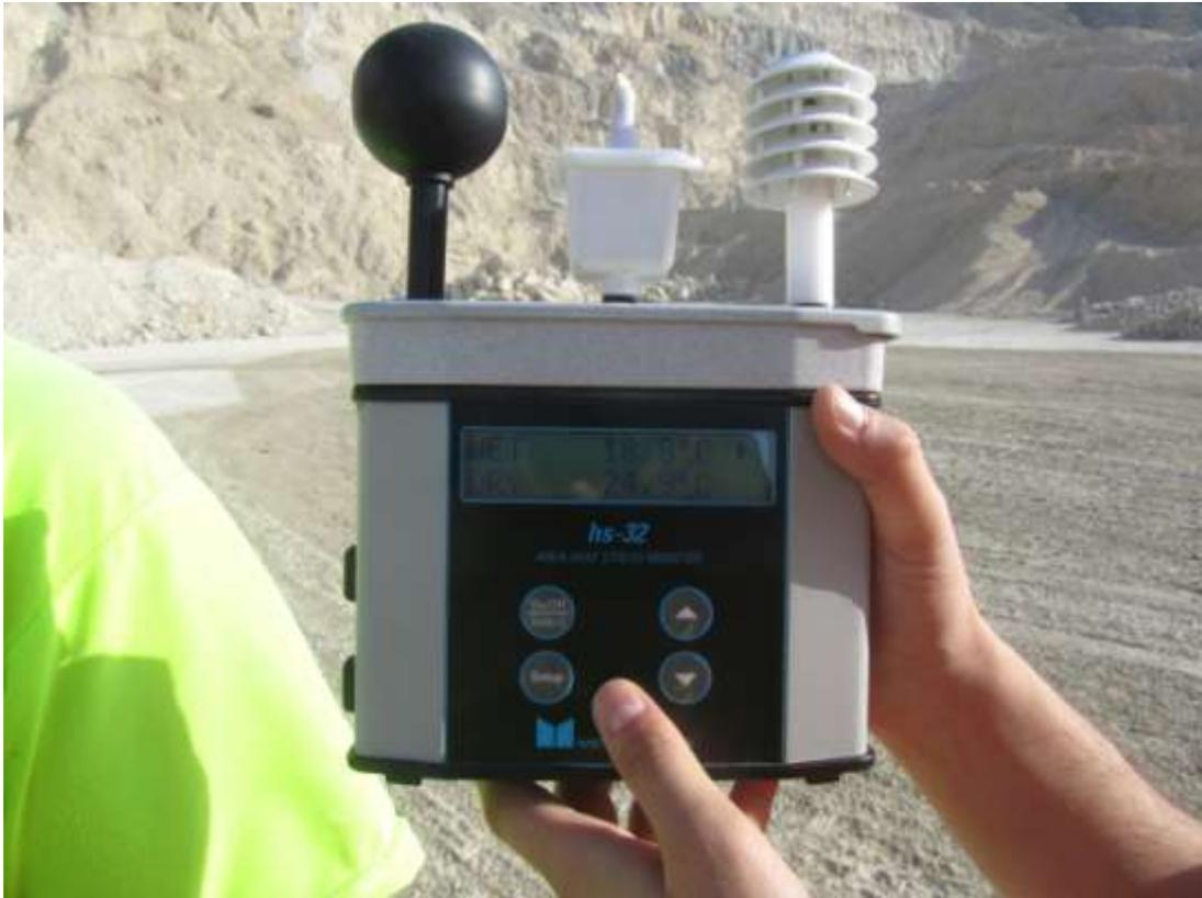
**Ilustración 20. Instrumento para medir el índice WBGT.**
