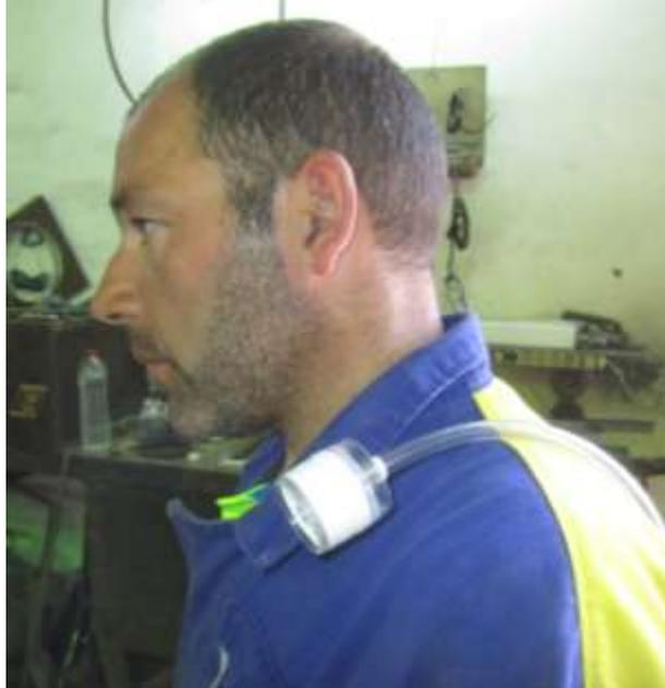
Ilustración 34. Filtro para la captación de partículas procedentes de los humos de soldadura.
