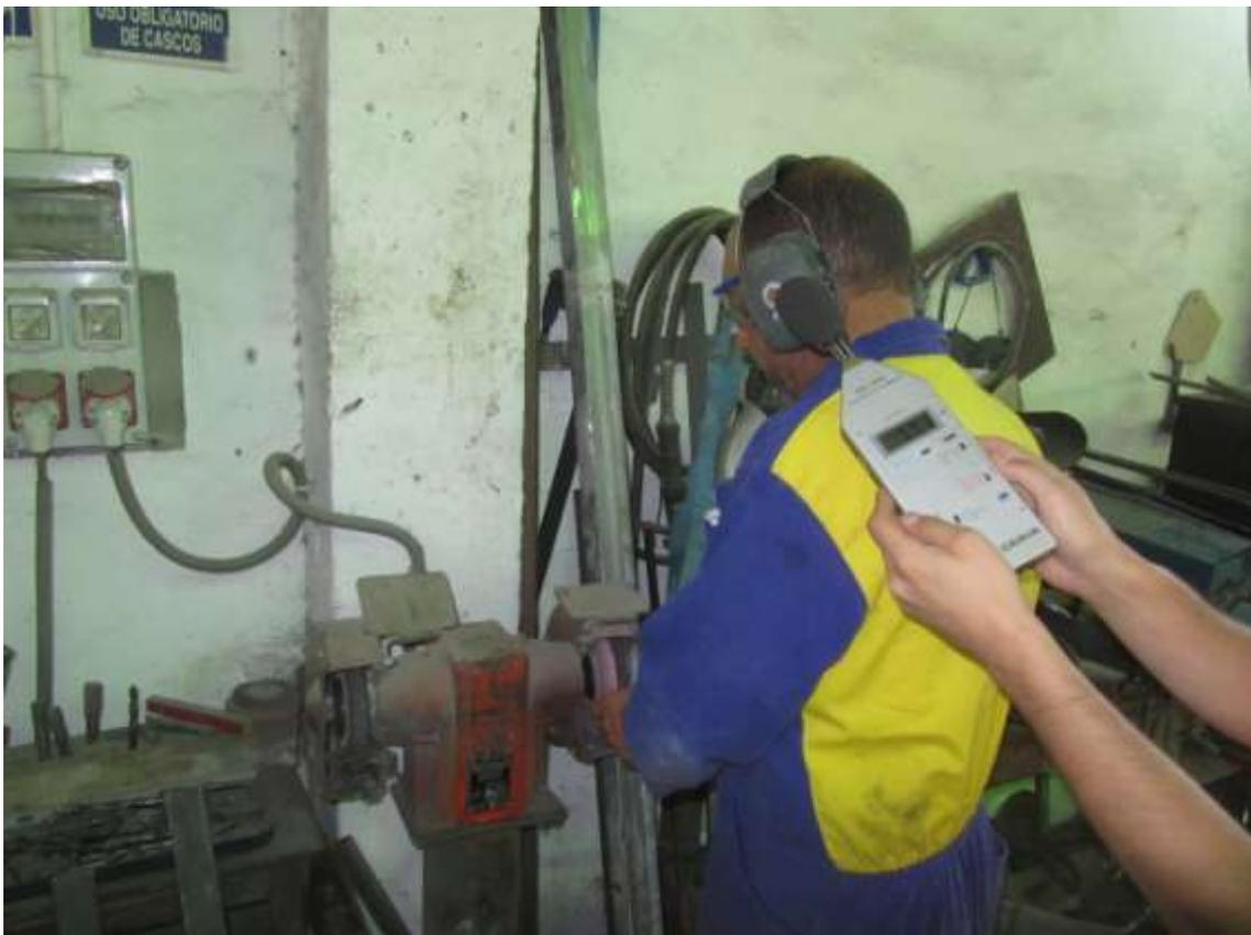
**Ilustración 9. Medida del ruido con un sonómetro.**
