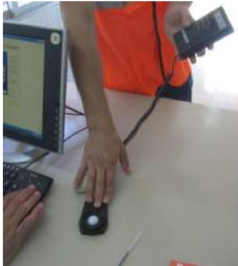
Ilustración 21. Medición de la iluminación.
