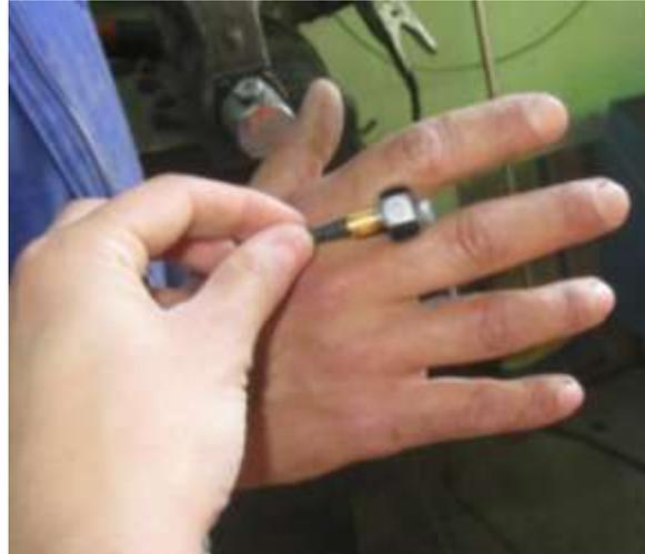
Ilustración 13. Medición de las vibraciones Mano-Brazo.
