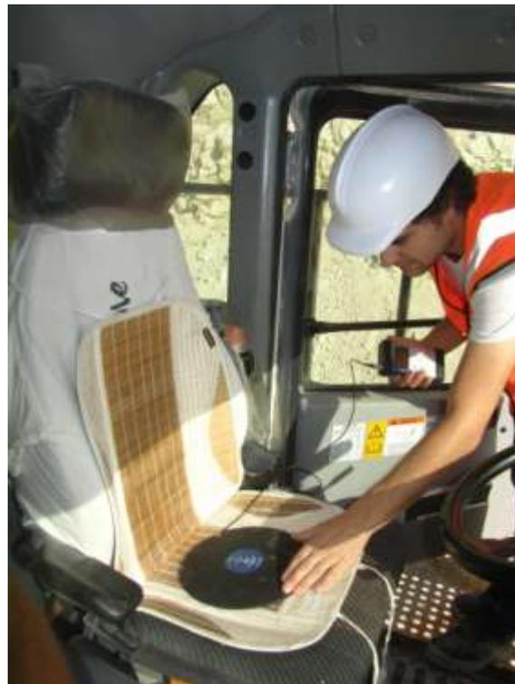
Ilustración 14. Medición de las vibraciones de cuerpo entero.
