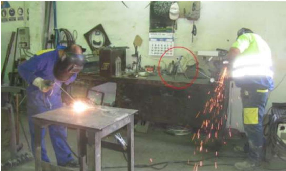
Ilustración 16. Medición de las radiaciones no ionizantes procedentes de trabajos de soldadura.
