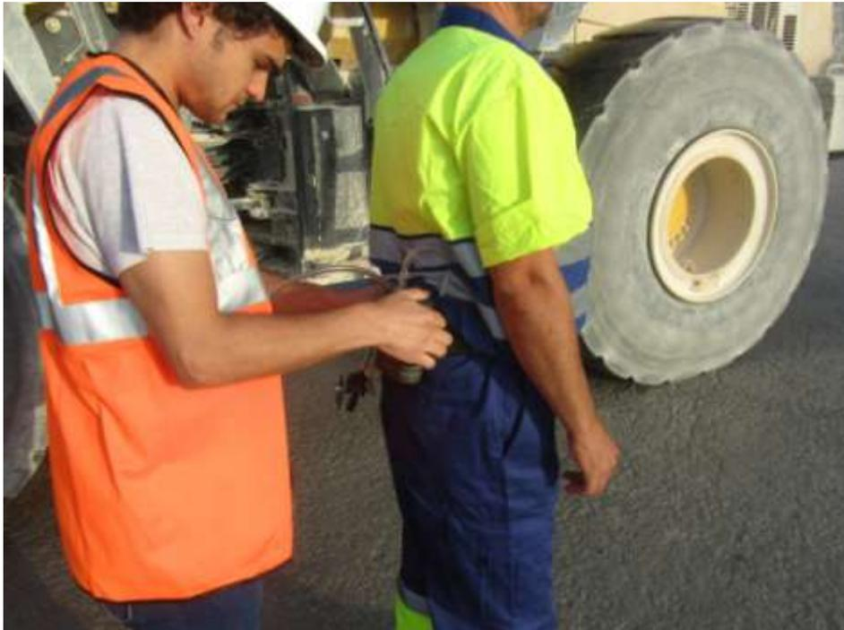
Ilustración 28. Bomba de aspiración colocada en el trabajador.
