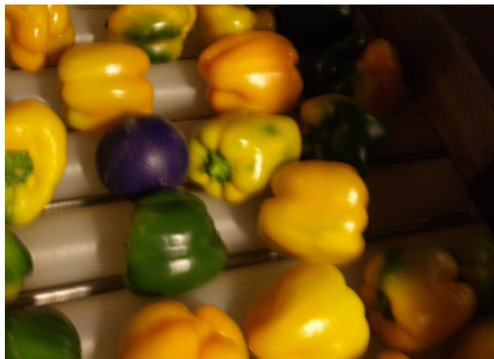
Foto 6-3: Esfera circulando por el transportador de rodillos
