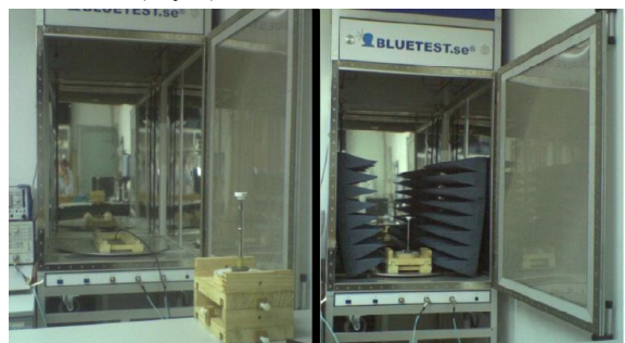
Figura 1. Configuración de la cámara de reverberación para la emulación de los escenarios C en la izquierda y F en la derecha.
