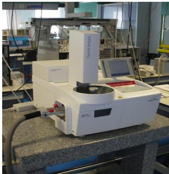
**Figura 54.** Analizador termogravimétrico TGA/DSC 1HT de Mettler-Toledo
