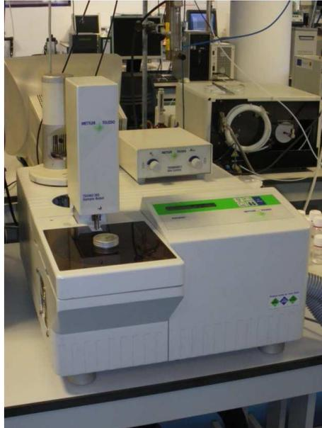
**Figura 53.** Calorímetro de barrido diferencial DSC-822 Mettler Toledo.
