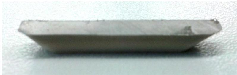
**Figura 59.** Probeta tras la metalización.
