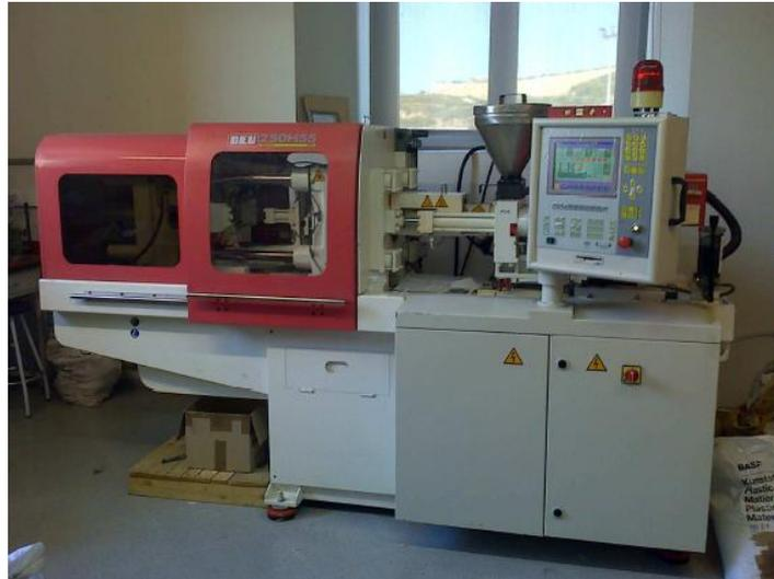
Figura 41. Máquina inyectora DEU 250H55 mini VP.
