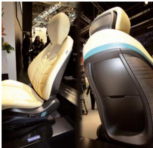
**Figura 1.** Respaldos de asientos basados en las nuevas tecnologías de plástico. BASF
