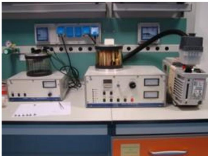
**Figura 56.** Sistema de metalización SC7610 de Quorum Technologies
