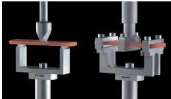
Figura 52: Modo de flexión en tres puntos (izquierda) y viga biempotrada (derecha).
