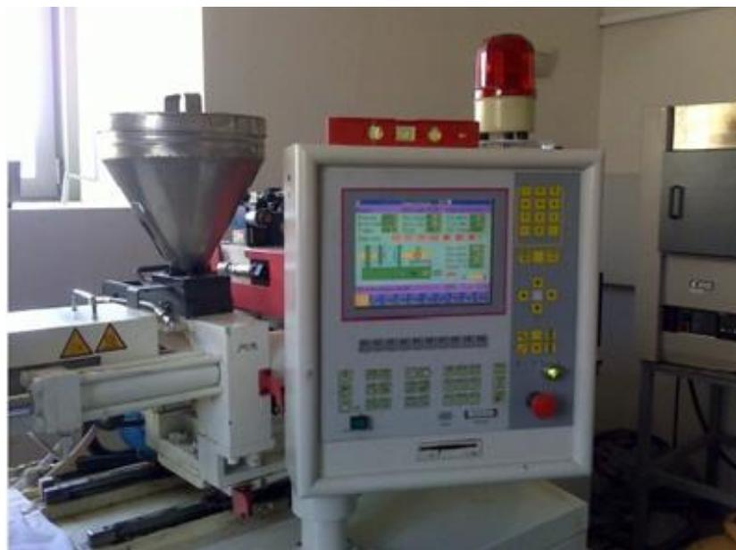
Figura 44: Unidad de control de la Máquina inyectora DEU 250H55 mini VP.
