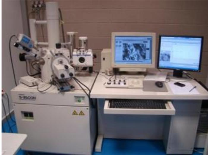
**Figura 55.** Microscopio electrónico de barrido S-3500N de HITACHI
