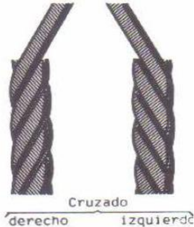
Fig. 6.3.2.9.6. Trenzado con torsión cruzada
