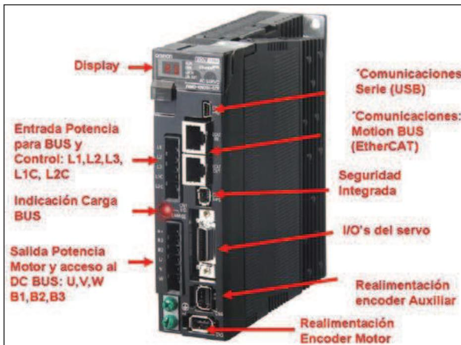
FIG 2.11. Servo controlador Accurax G5.
