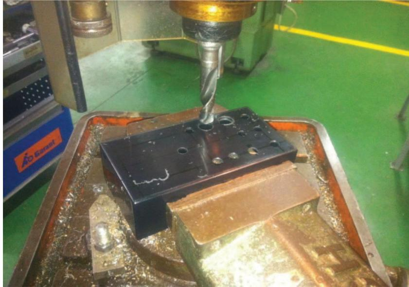
FIG.4.17. Realización de taladros sobre panel de control.
