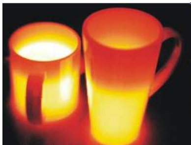
Figura 1. Termografía de calentamiento por microondas para dos tazas de café con calentamiento mayor en su interior (colores más claros).
