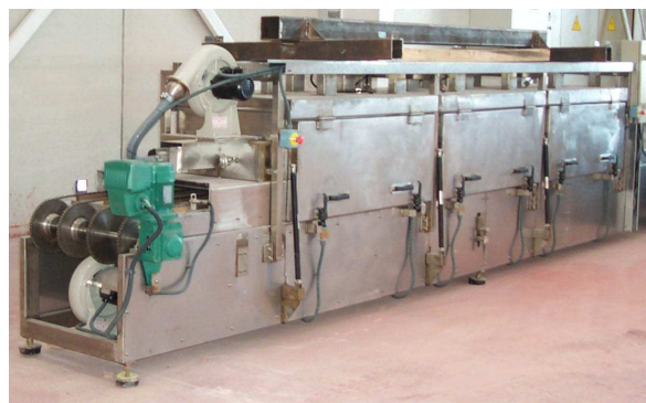
Figura 2. Horno de microondas para el curado de las cubiertas de resina en la industria del mármol.
