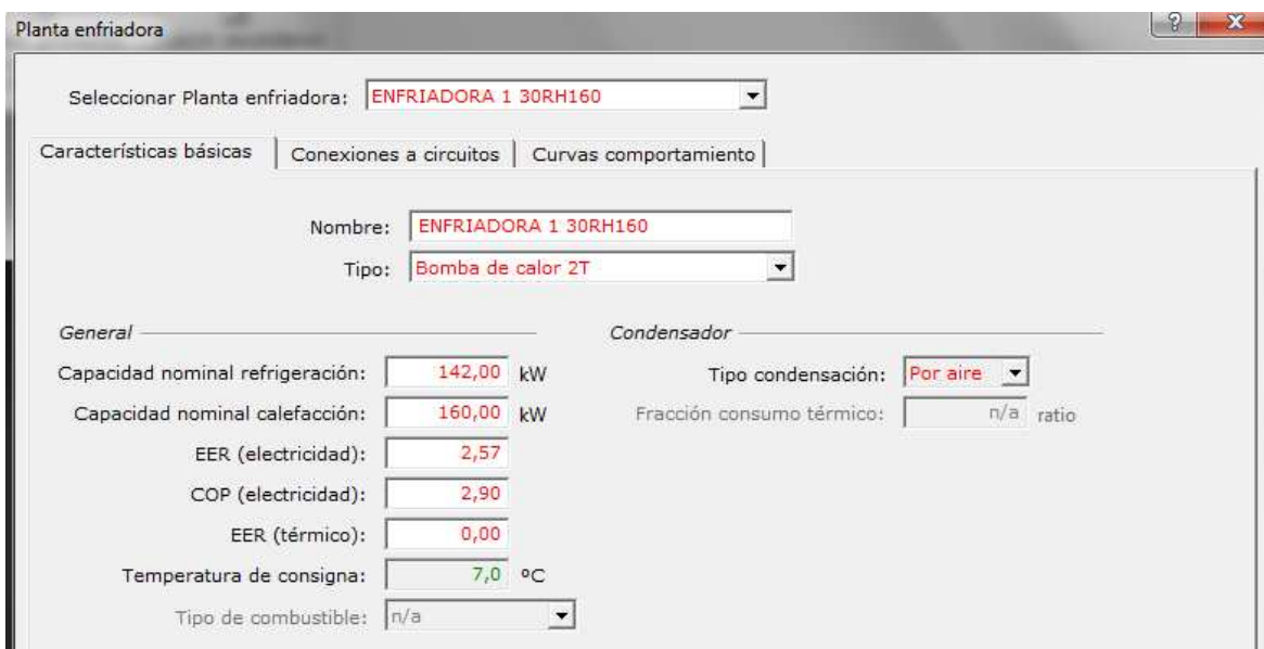
Figura 89. Mejora 3: Sustitución de enfriadoras en CALENER GT.
