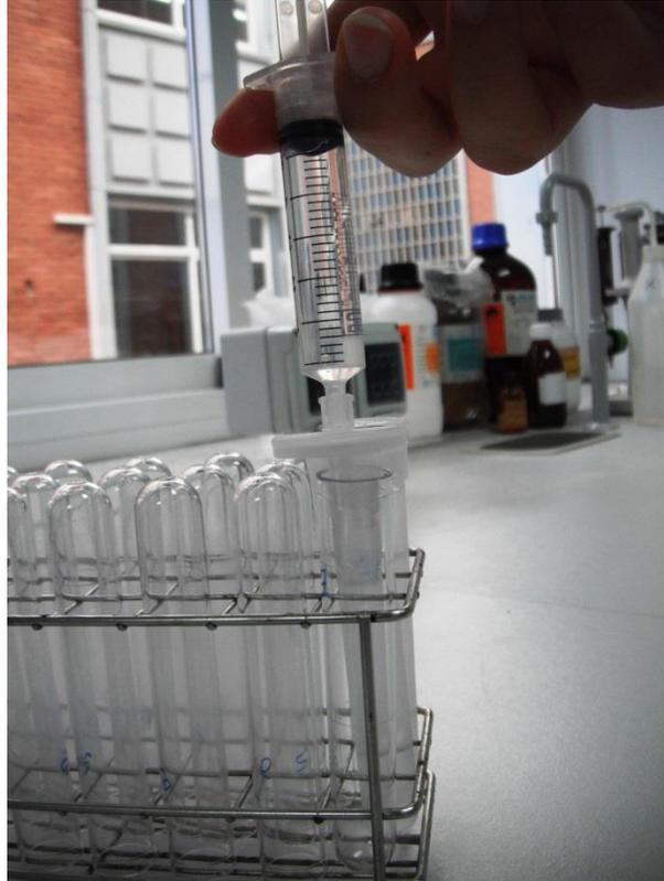
**FIGURA IV.6.-** DETALLE DE FILTRACIÓN DE LA MUESTRA.
