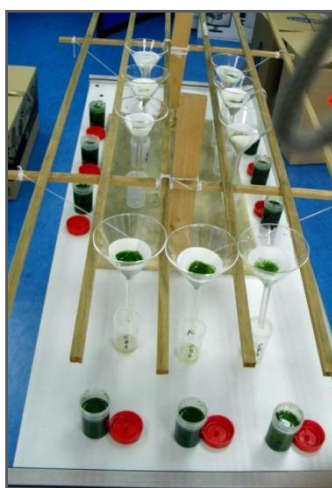
Figura 77:Estructura para la filtración.
