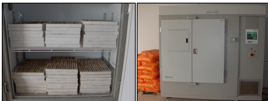
Figura 33: Bandejas en el interior de la cámara climática y exterior cámara climática.
