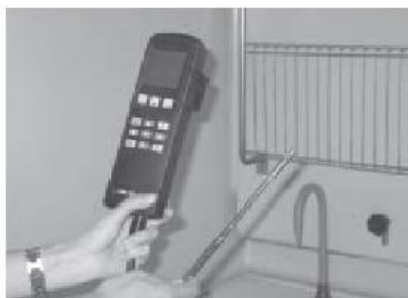
Figura 3.1 Medida de la velocidad del aire con anemómetro
