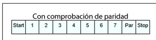
**Figura 3. 8:** Composición de un baudio de información en Modbus ASCII
