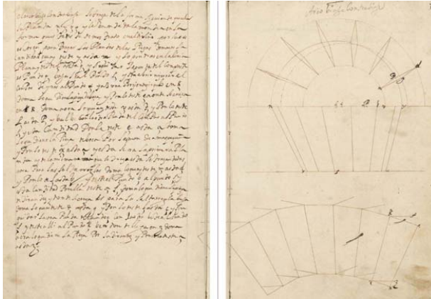
Fig 1. Arco abocinado. C. 1550. BNE. Ms.12686.
