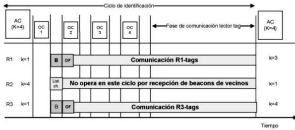
Figura 2 Ejemplo de ciclo de identificación del protocolo NFRA en el escenario de la figura 1
