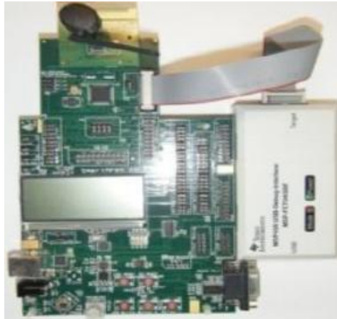
Figura 3.9: Nodo sensor completo conectado al MSP-FET430UIF
