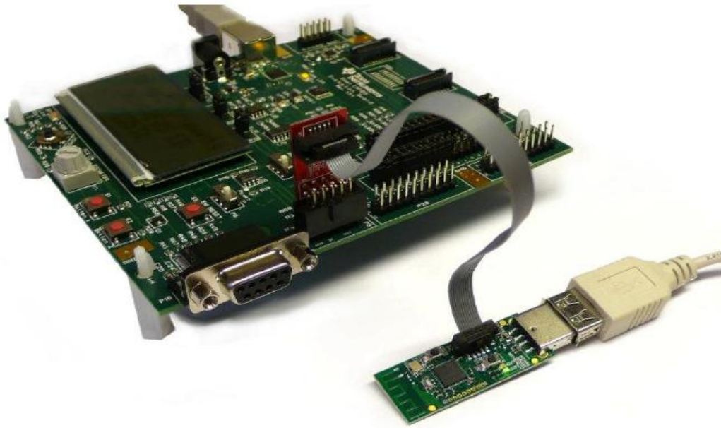
Figura 3.5: Adaptador USB conectado con SmartRF05EB
