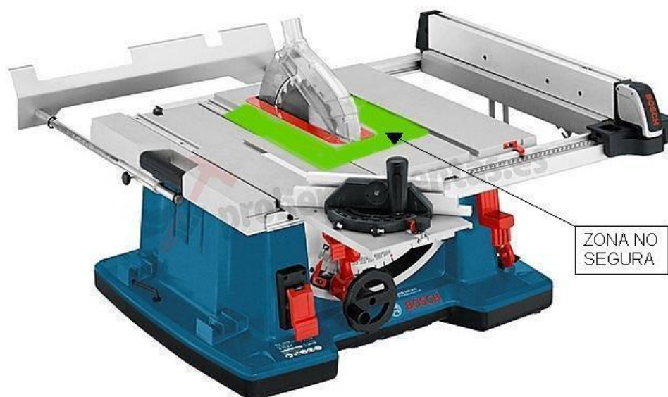
Figura 10. Ejemplo de zona no segura en sierra circular.
