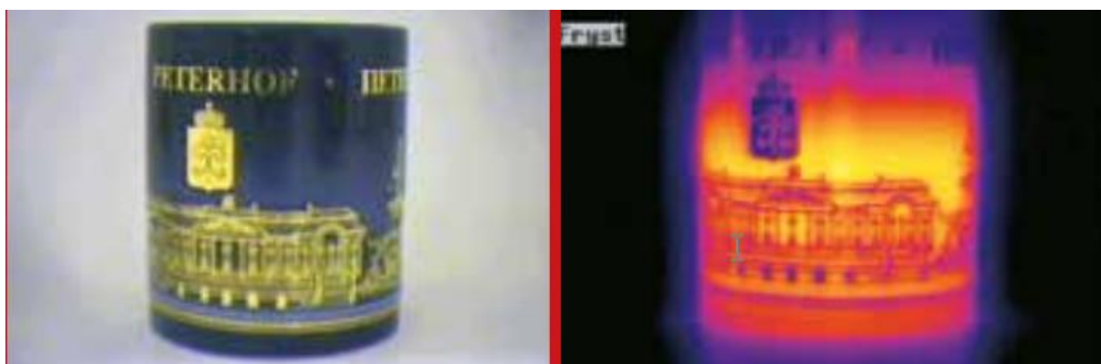
Figura 8. Influencia de la emisividad. Los diferentes colores vienen de la diferente emisividad de la pintura dorada y negra, aunque las temperaturas son idénticas.
