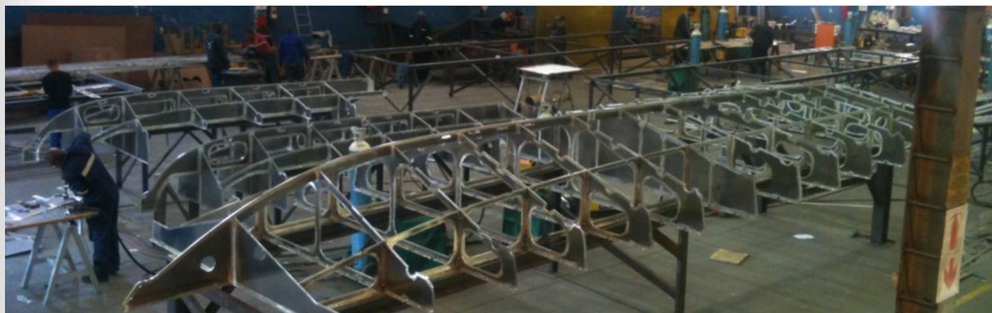
Operarios fabrican uno de los buques interceptores de gran velocidad diseñados por Enrique Sanmartín para el Gobierno de Namibia.
