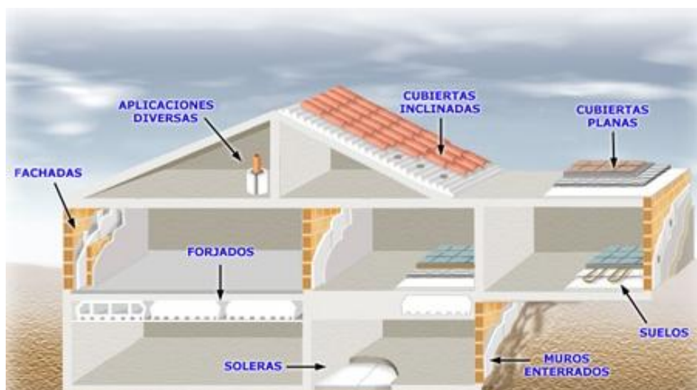
Ilustración 9. Aplicaciones EPS en edificación
