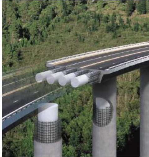
Ilustración 7. Uso EPS en obra civil
