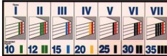
Ilustración 5. Clasificación poliestireno expandido según su densidad
