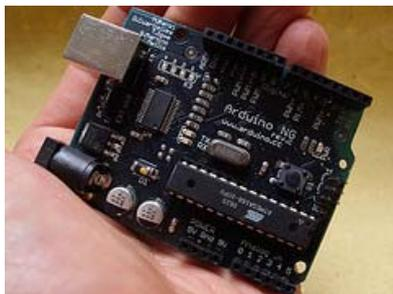
○ **Arduino NG.** Usa el convertor serie a USB FTDI FT232RL, el cual necesita menos componentes externos que el FT232BM. Este también posee un LED en el pin 13, aunque en su última revisión se eliminó este LED porque podía interferir con la comunicación SPI. Originalmente comercializado con el ATmega8, paso a producirse en base al ATmega168.
