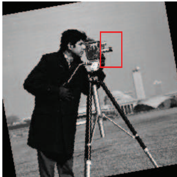
Figura 5.5: Reconocimiento del patrón dentro de la imagen rotada 10 grados
