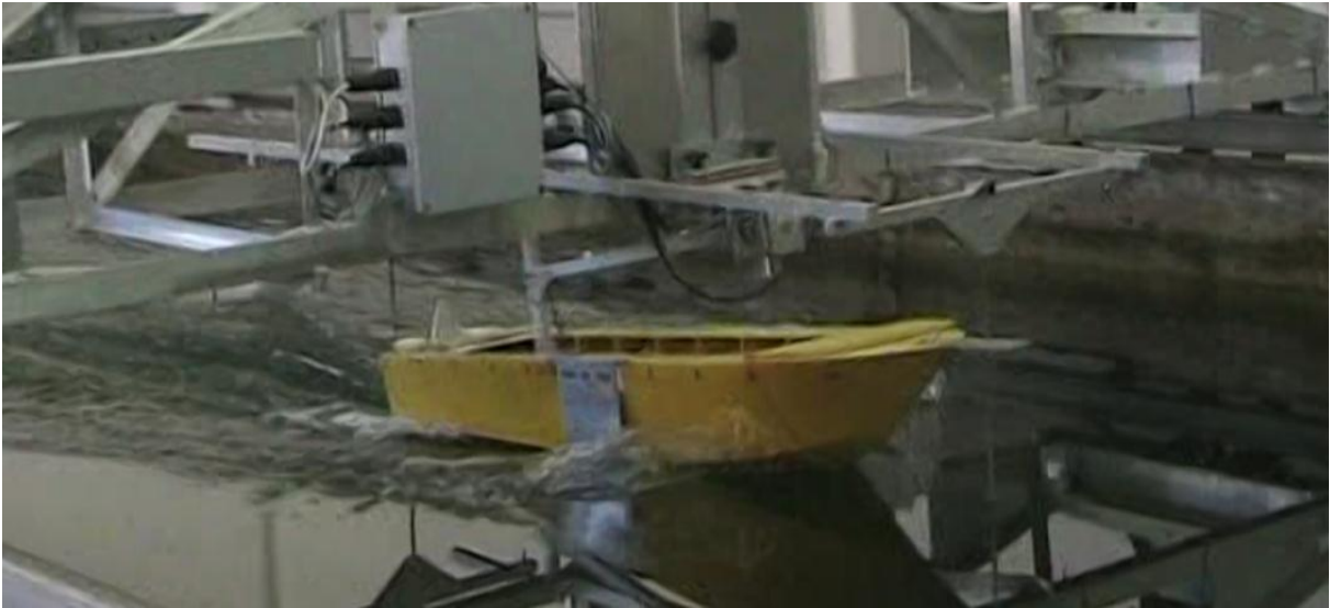
Carena con perfil nº 1, 0.75c de la quilla, ángulo de ataque 6°; F_n=0.70
