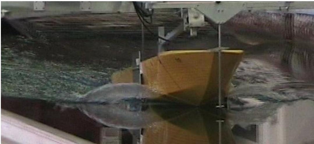
Ensayo con el modelo sobre el canal.
