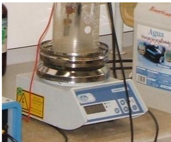
Ilustración 6. Calentador/agitador magnético
