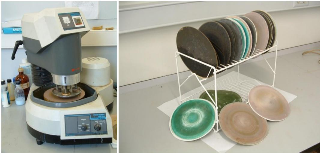
Ilustración 2. Pulidora metalográfica y papeles de desbaste
