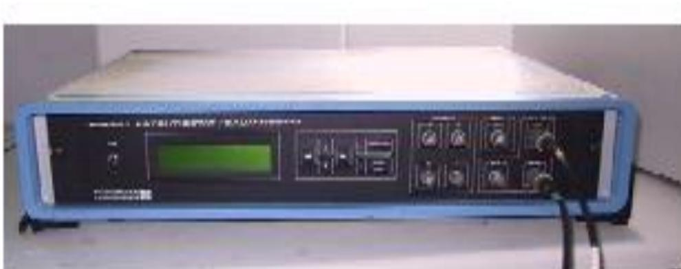
Ilustración 5. Potenciostato/galvanostato VoltaLab
