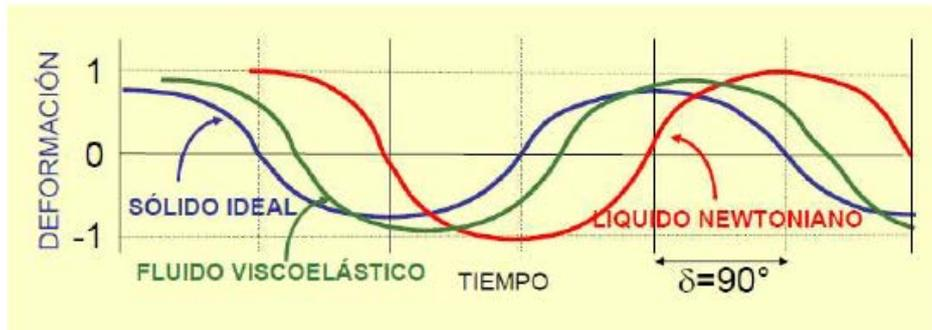
Figura I.32. Representación de modelos de sólido elástico, líquido viscoso y material viscoelástico.
