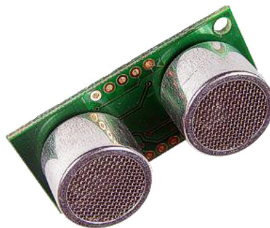
Ilustración 13: Sensor ultrasónico SRF05
