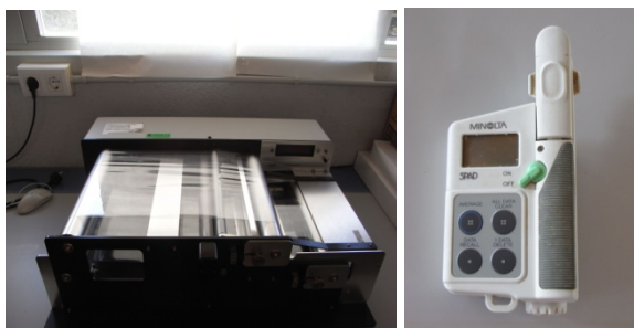
Figura 5.6.- Medidor de área foliar modelo LI-3100C (LI-COR) (izquierda) y SPAD- 502 (Konoca-Minolta) (derecha)
