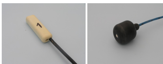
Figura 5.3.- Sondas conductividad eléctrica (izquierda), oxígeno disuelto en agua (derecha)
