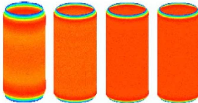
Fig.35 – Cáscara cilíndrica fina. Mallados 2-5. Representación del contorno del desplazamiento radial
