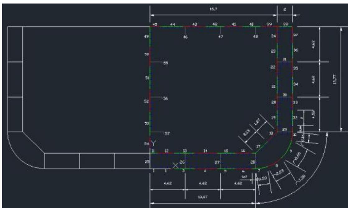
Fig.2–Detalle de la sección media del buque con la definición de las chapas (plates)
