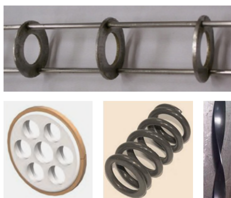
Figura 1.4: Otros elementos insertados en columnas de flujo oscilatorio. Disco con un único orificio (a), disco con múltiples orificios (b), muelle helicoidal (c), lámina ondulada (d).
