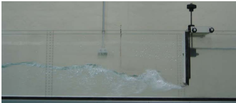
Fotografía I.2 - Resalto hidráulico libre estabilizado inmediatamente aguas abajo del pie de la compuerta.
