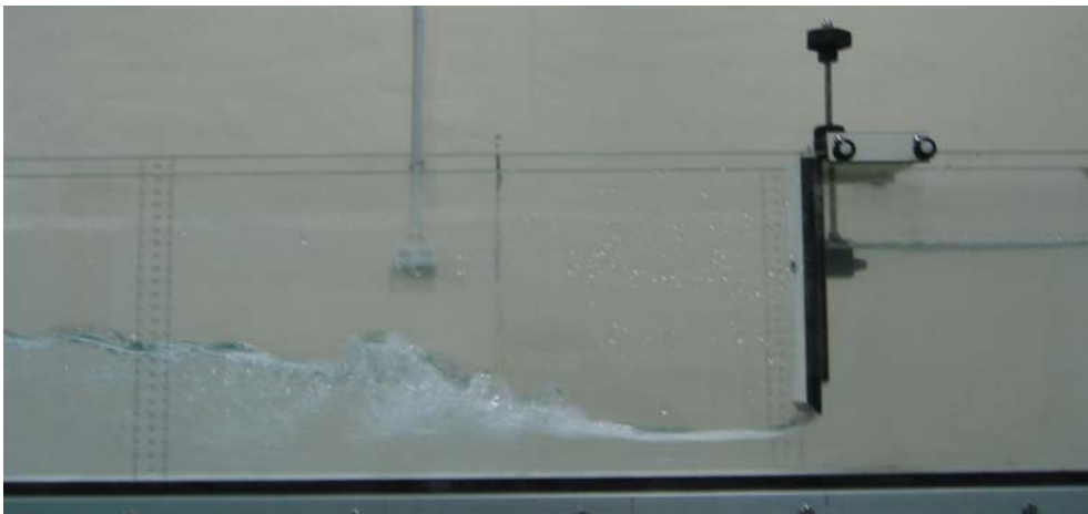
Fotografía VI.1 - Resalto hidráulico libre.
