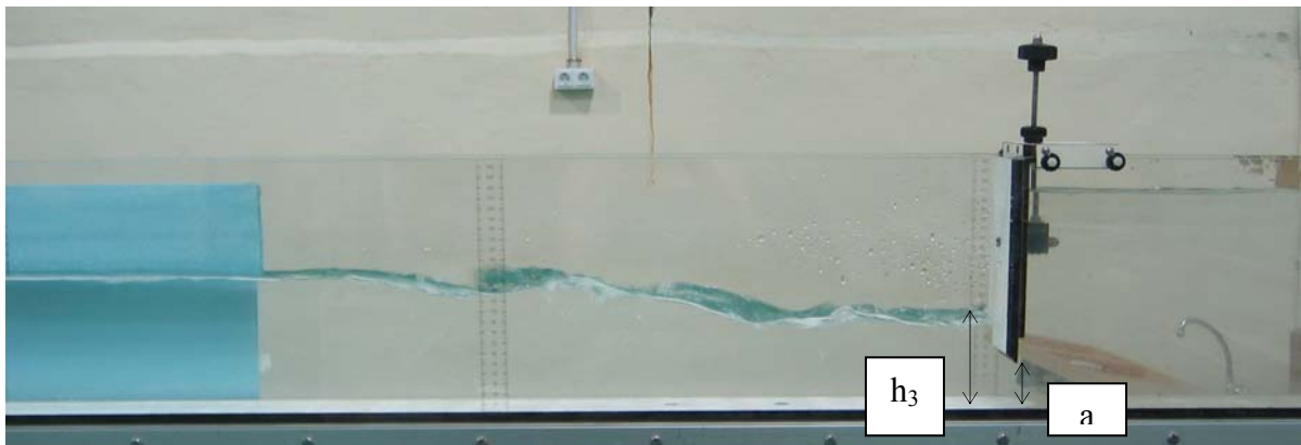
Fotografía VI.3 - Resalto hidráulico sumergido.
