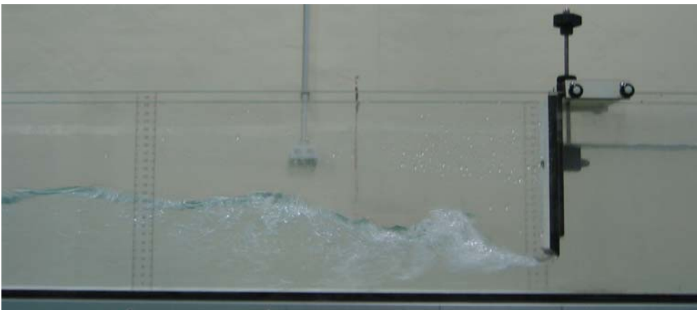
Fotografía VI.2 – Resalto hidráulico libre al pie de la compuerta.
