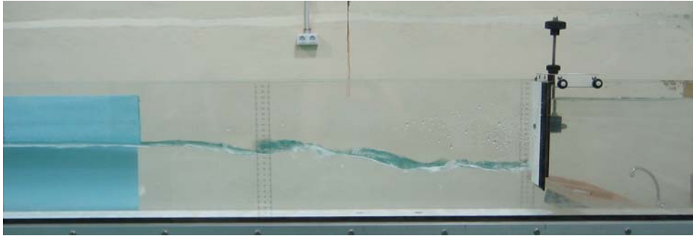
Fotografía I.3 - Resalto hidráulico sumergido.
