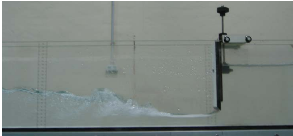
Fotografía I.1 - Resalto hidráulico libre estabilizado a 14 centímetros de la compuerta.
