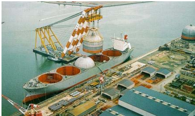
Montaje tanques gasero, cuerpo cilíndrico, fondo superior esférico
