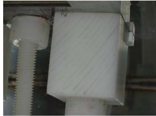
Figura 3.22. Acoplamiento entre los ejes y la cavidad.
