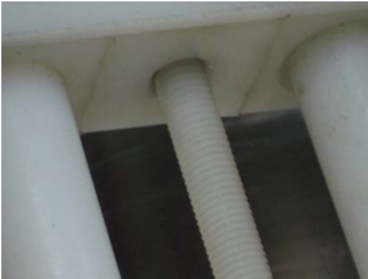
Figura 3.21. Pieza que transforma rotación en translación.
