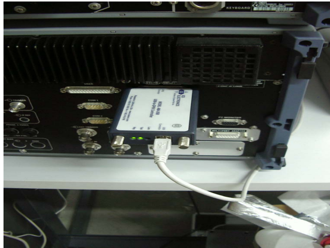
Figura 3.17. Conector GPIB-USB (Analizador, cara trasera).
