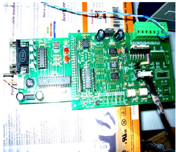
Figura 3.24. Tarjeta con microcontrolador para manejar el motor.
