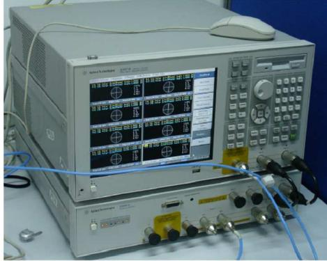
Figura 6: Analizador del que dispone el grupo SiCoMo para medidas en el dominio de la frecuencia.
