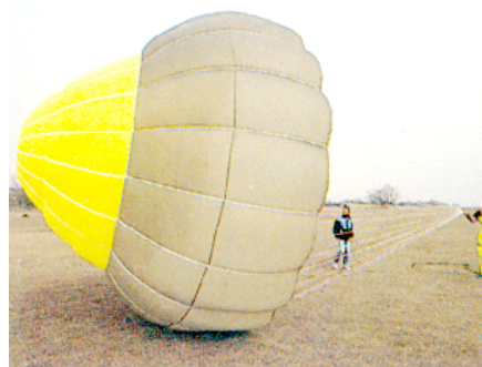
Figura 6: paracaídas tipo cónico de dos porosidades
