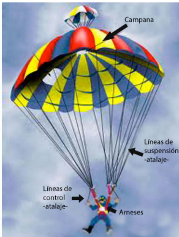
Figura 4: elementos de un paracaídas
