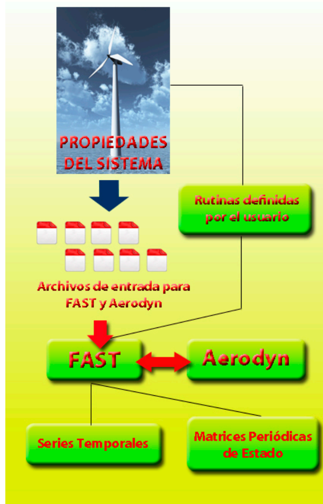
Figura 1: Modos de operación de FAST
