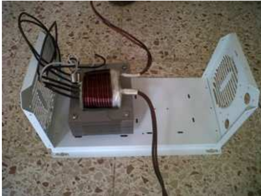
Imagen 8. Transformador 1.5 KW en la carcasa
