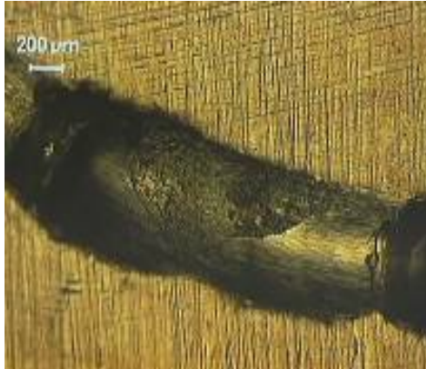
Figura 4.42. Micrografías: a) óptica y b) electrónica de la huella en presencia de a) L-108 y de b) a 200°C.
