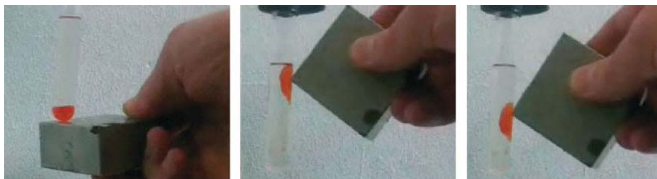
Figura 1.19. Respuesta del [\text{HexMeIm}]_3[\text{Dy}(\text{SCN})_6(\text{H}_2\text{O})_2] ante un imán de neodimio.
