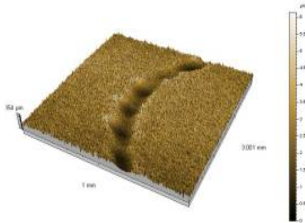
Figura 4.45. Relieve de la huella de desgaste de la probeta de titanio tras el ensayo en presencia del LP-106 mostrada en la figura 4.42.
