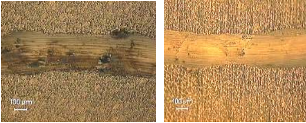
Figura 4.17 . Micrografía óptica de la huella en la superficie del titanio tras el ensayo con a)L-108 y b) LP-106.
