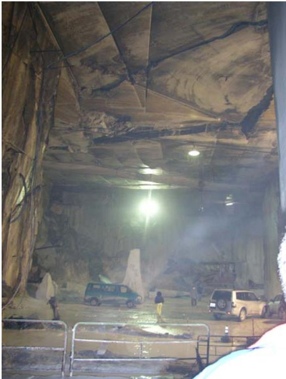
Se avanza en galería de 3 metros y se banquea mediante 3 bancos de 4 a 5 metros que no siempre se extraen, pudiendo quedar como viga de refuerzo entre las bases de dos pilares consecutivos cuando el mármol es de baja calidad. En los pilares se produce estallido de roca por lo que se suelen colocar bulones de 2 m en malla 2 x 2 cuando se observa esta tendencia. El aprovechamiento está en torno al 35%.
