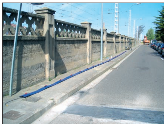
[Foto 2]. - Land Streamer con geófonos a un metro de distancia para el registro de las ondas Rayleigh en un ensayo MASW.
