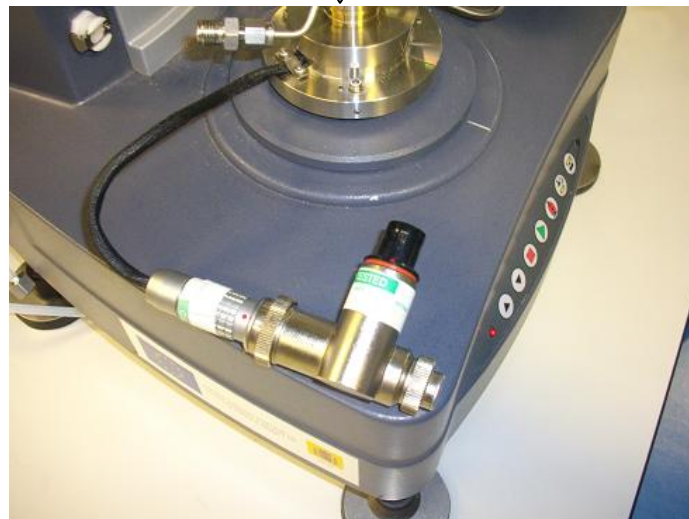
Figura 2.19. Una vez que se ha quitado el primer colector, y se desenchufa el de forma de T, se puede quitar el segundo.
