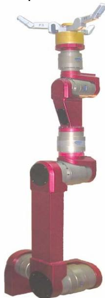
*Figura 3.13.- Brazo Robotnik con una mano incluida*
