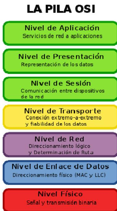
*Fig.3.15.- Protocolo de capas*
