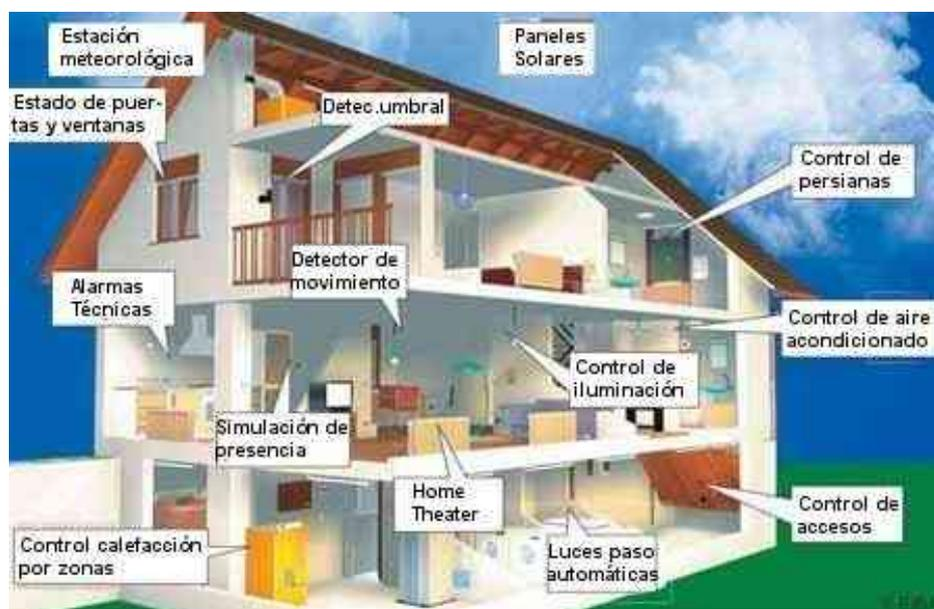
Fig. 4.1.- Ejemplo de casa con un sistema de control central
