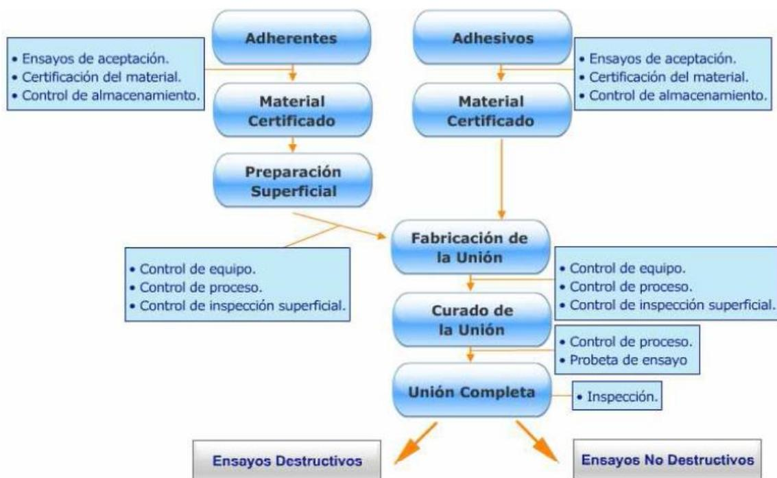
Fig.9.1. Plan de control de calidad.
