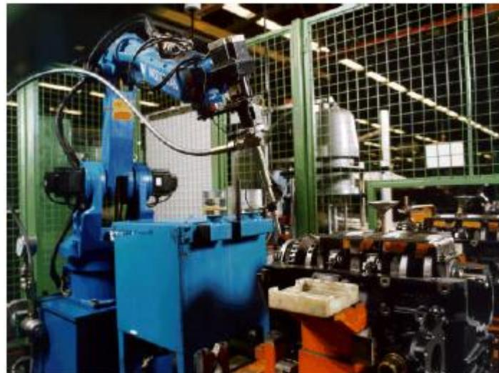
Fig.5.4 Ejemplo de aplicación de siliconas en líneas de producción.
