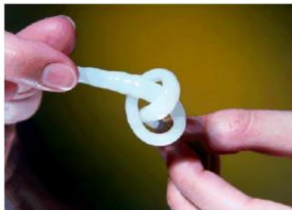
Fig.5.2. Aspecto de un adhesivo elástico.
