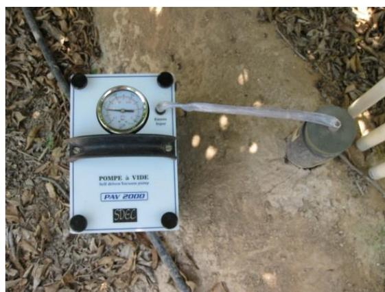
**Fotografía 4:** Bomba de vacío y lisímetro de succión.
