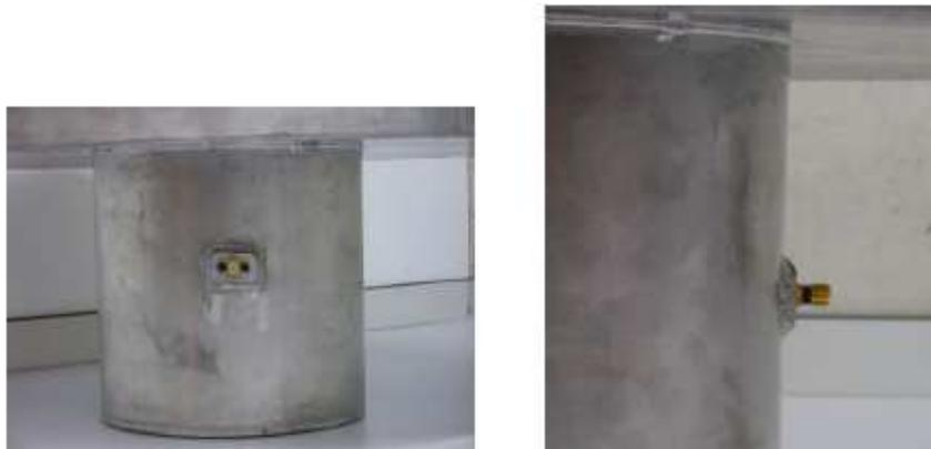
Figura 3.27. Sonda coaxial en la bocina fabricada
