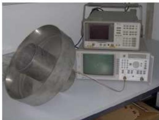
Figura 3.28. Conexión de la bocina excitada con el analizador
