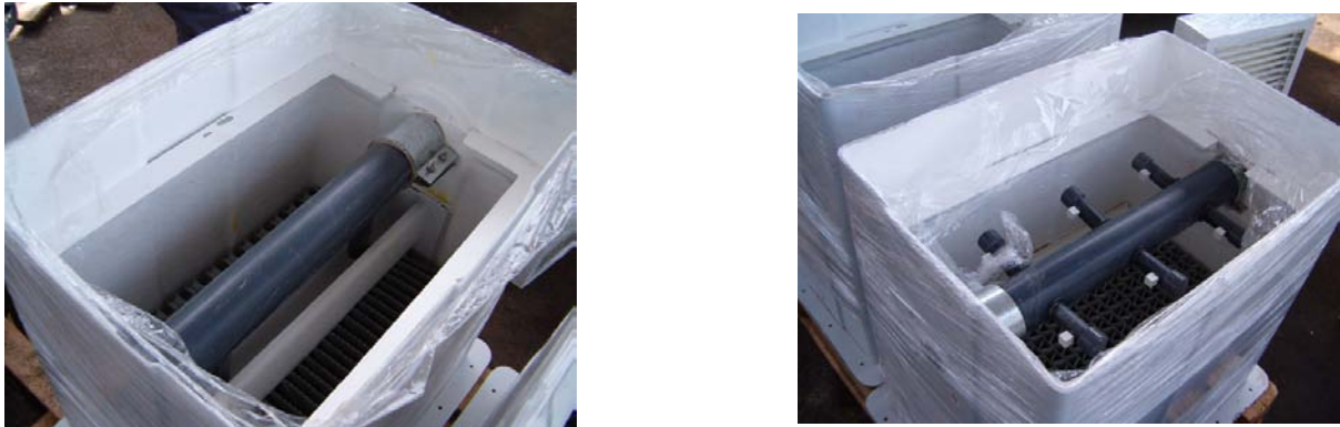
Figura 4: Sistemas de distribución ensayados. Sistema por gravedad (izquierda) y sistema por presión (derecha).
