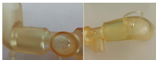
Figura 14. Prototipo impreso en resina biocompatible para comprobación de sellado y pruebas funcionales
