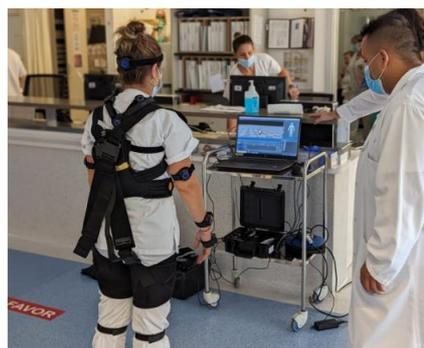
**Figura 11.** Mocap, sEMG y exoesqueleto durante el ensayo
