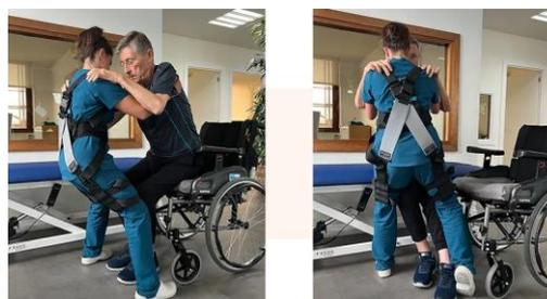
**Figura 5. Exoesqueleto textil HELK**
