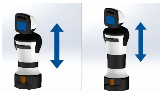
Figura 1. Movimiento vertical del cuerpo del robot móvil asistencial.
