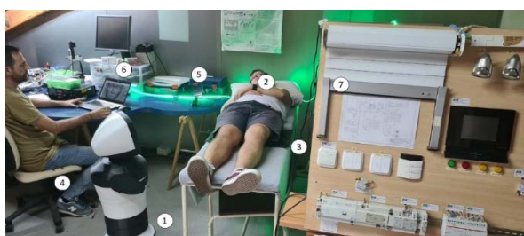
Figura 5. AAL + instalaciones del laboratorio de robótica en UPCT. Escenario de prueba "Inicio del día": (1) robot Echo: Base Turtlebot impresa en 3D con Echo 8 y Alexa en la cabeza; (2) sujeto vistiendo la Empatica E4; (3) detector de presencia en cama; (4) detector de presencia en silla; (5) interfaz de usuario AAL; (6) simulación de detección de estado de atención al ver la TV; (7) simulador de otros elementos domóticos. Referencia (Barber,2022).
