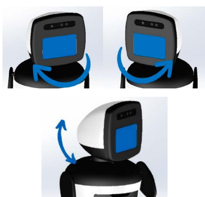
Figura 2. Movimientos de la cabeza del robot móvil asistencial.
