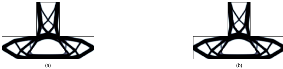
Figura 11. Estructura T-invertida. Diseño óptimo robusto considerando incertidumbre en la magnitud y dirección de la carga para la configuración 1 ( \sigma_\theta=0,25 ). (a) MC, (b) MCK.
