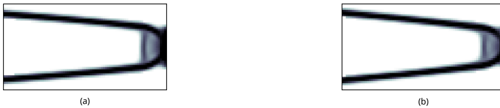
Figura 6. Viga en voladizo. Diseño óptimo robusto considerando incertidumbre en la posición de la carga. (a) MC, (b) MCK.
