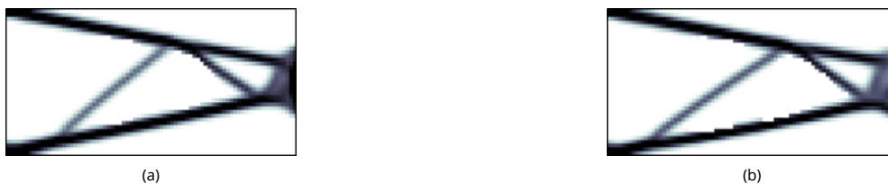
Figura 8. Viga en Voladizo. Diseño óptimo robusto considerando incertidumbre en la magnitud, en la dirección y en la posición de la carga. (a) MC, (b) MCK.
