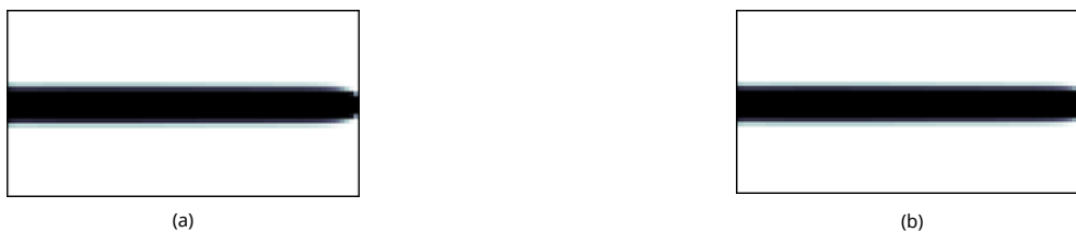
Figura 4. Viga en voladizo. Diseño óptimo robusto considerando incertidumbre en la magnitud de la carga. (a) MC, (b) MCK.
