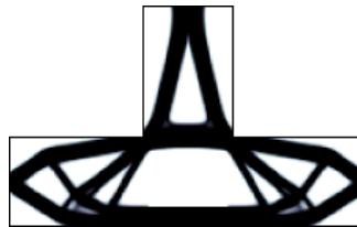
Figura 10. Estructura T-invertida. Diseño óptimo determinista.
