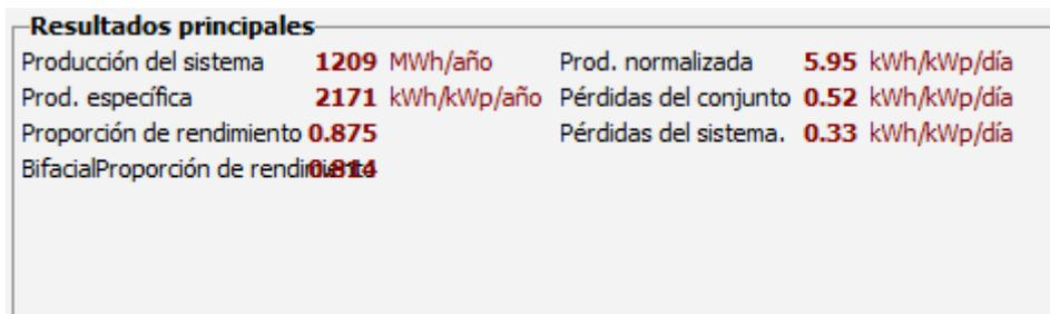
Figura 80: Resultados de la instalación solar bifacial a 4 metros
